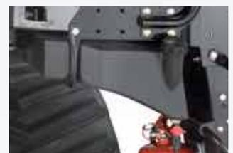
Der integrierte Wassertank ist an der idealen Stelle zum Händewaschen vor dem Einstieg in die Kabine angebracht.
