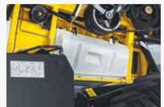
Die Kunststoff-Rotorabdeckungen können ohne Werkzeug demontiert werden.
