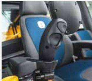
Umschalttaste und Entsperrung des Fahrhebels (hinten).
