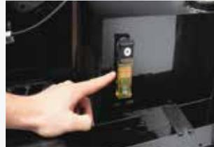
Alle Ölfilter und Ablassöffnungen sind bequem vom Boden aus erreichbar; die Schmierbänke sind zentral angeordnet.
