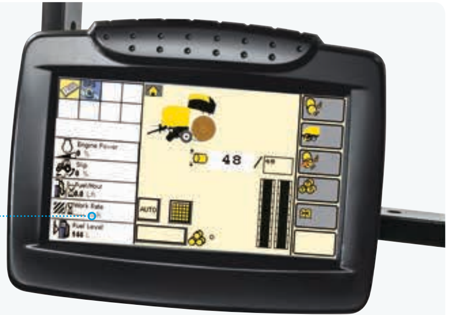
Allradantrieb und Differenzialsperre werden per Fingertipp eingeschaltet.
