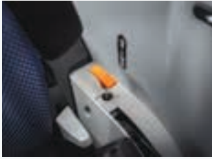
Umschaltung Motorzapfwelle / Wegzapfwelle.
